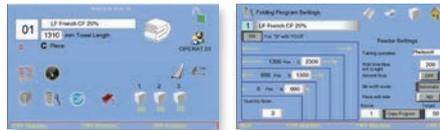
La piegaspugne **T.towel** ha un PLC basato su controllo di sistema tramite un facile schermo tattile a colori 7". Il sistema di controllo ha bisogno di un computer potente e pertanto TEXFINITY ha scelto un plc della OMRON. Questo potente processore permette di ottenere il massimo della precisione nella piegatura, testata con dei test comparativi. Grazie al touchscreen reattivo di alta risoluzione, diventa estremamente facile costruire o modificare i programmi di piegatura.
