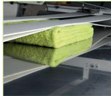
Dopo aver terminato il processo di piegatura, i pezzi sono impilati su di un accatastatore dedicato. Il modello standard della Piegaspugne **T.towel** è provvisto di 3 stazioni di accatastamento, come optional è possibile avere il 4° accatastatore come anche un accatastatore con una larghezza differente.
